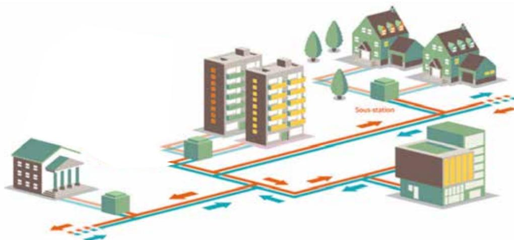
Maquette type d'un réseau de chaleur avec canalisations enterrées et de sous-stations pour la livraison d'une chaleur domestique au sein des bâtiments
