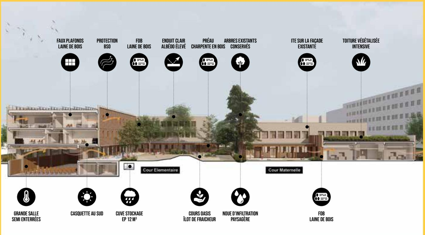
↳ L'ensemble des bâtiments profite d'un design bioclimatique et de matériaux biosourcés.
